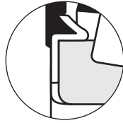
Fig. 1. Respaldo del borde contra la cara posterior del sello
