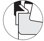
Fig. 2. Respaldo del borde contra la cara posterior del cono (anillo interno) (debajo del sello).
